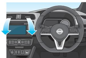
クルマに乗りこむ前に、車内を設定した温度にするよう、あらかじめ暖房または冷房を作動することができたり、車室内温度(目安)の確認もできます。充電コネクタが接続されていれば、充電器から供給される電力で作動するので車載バッテリーの充電量は減りません。
